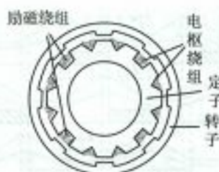
图5 电励磁双凸极电机结构示意图
