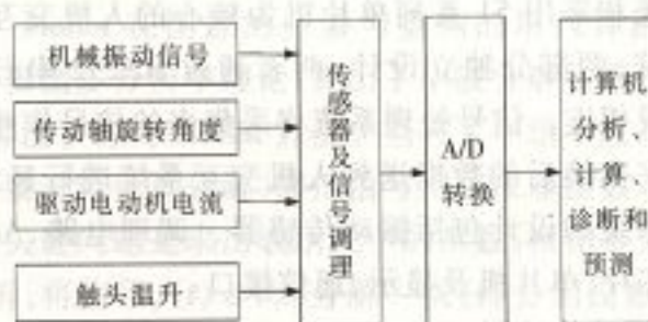
图1 OLTC监测与诊断系统的一般组成
